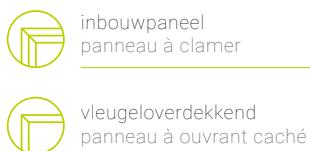
Les panneaux à clamer sont installés à la façon d'un carreau dans une fenêtre avec des parcloses (clipsables). Les joints (en caoutchouc) restent visibles entre le cadre de l'ouvrant et le panneau à clamer. Souvent, l'épaisseur est insuffisante pour réussir à atteindre certaines valeurs d'isolation.
