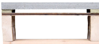
Plancher béton sur plancher bois
